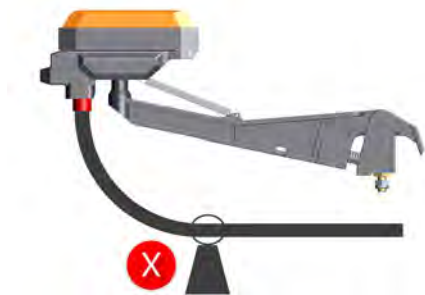
Anschlussleitung nicht belasten.
