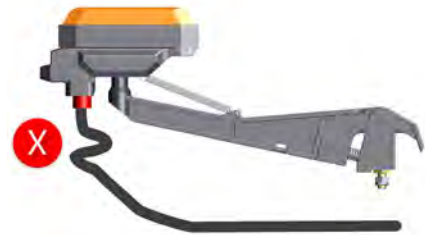
Anschlussleitung nicht aufliegen stauchen oder knicken.
