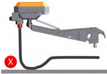
Anschlussleitung darf nicht aufliegen.
