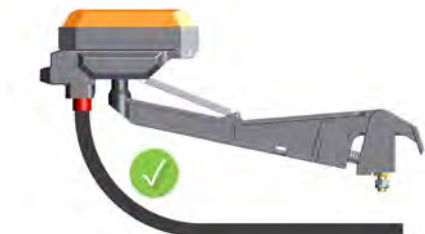
Anschlussleitung korrekt verlegt.
