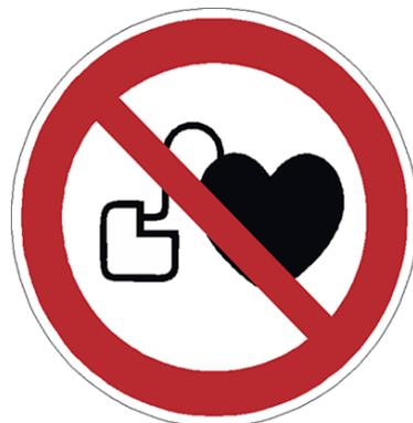
Abb. 2-1 Verbotsschild: „Kein Zugang für Personen mit Herzschrittmachern oder implantierten Defibrillatoren.“
